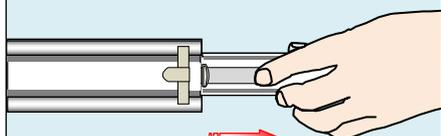
脱着レバーを押して矢印の方向に引くとインナーレールが外れます。
